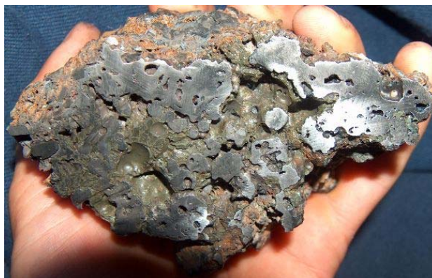
26. ábra: A 6. próbaolvasztás vasbucájának metszete
