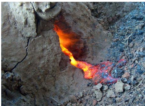
25. ábra: A folyósalak kicsapolása a 6. próbaolvasztáson
