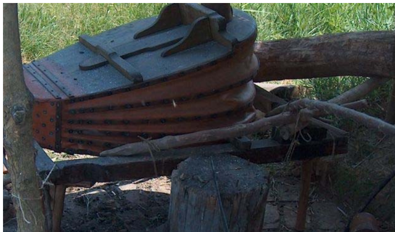
21. Kovácsfűjtató használata a hatodik próbaolvasztáson
