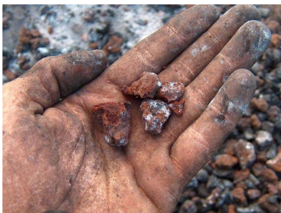
20. ábra: A pörkölés eredményeképpen vörösre színeződő érc
