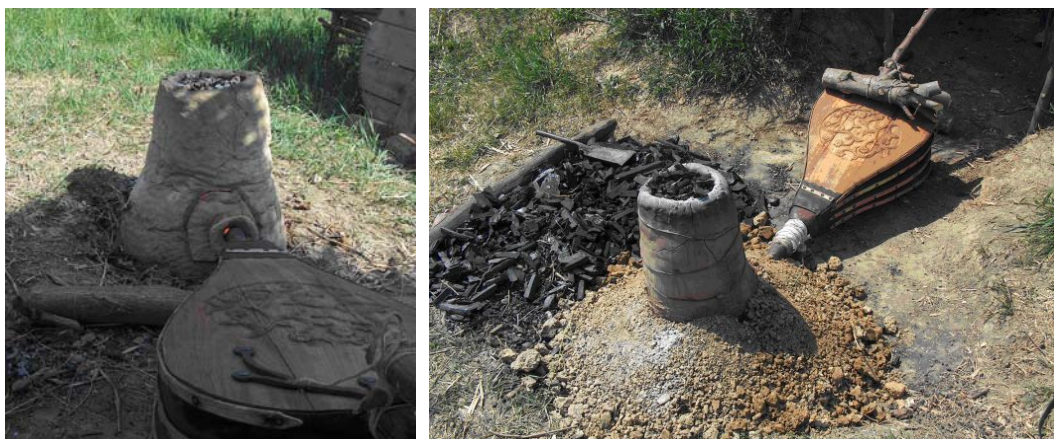
22. ábra: Az első próbaolvasztás nemeskéri típusú kohója, és ugyan ez a típus földel takarva a második próbaolvasztás során
